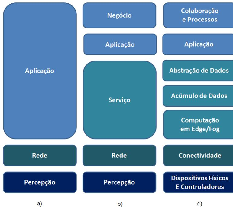
Fig. 2. Modelos Arquiteturais em IoT: a) Três Camadas. b) Cinco camadas. c) Sete Camadas.
