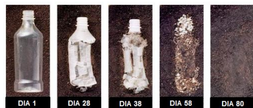
Figura 19. Processo de decomposição de um PET biodegradável (80 dias). Adaptado de [77].
